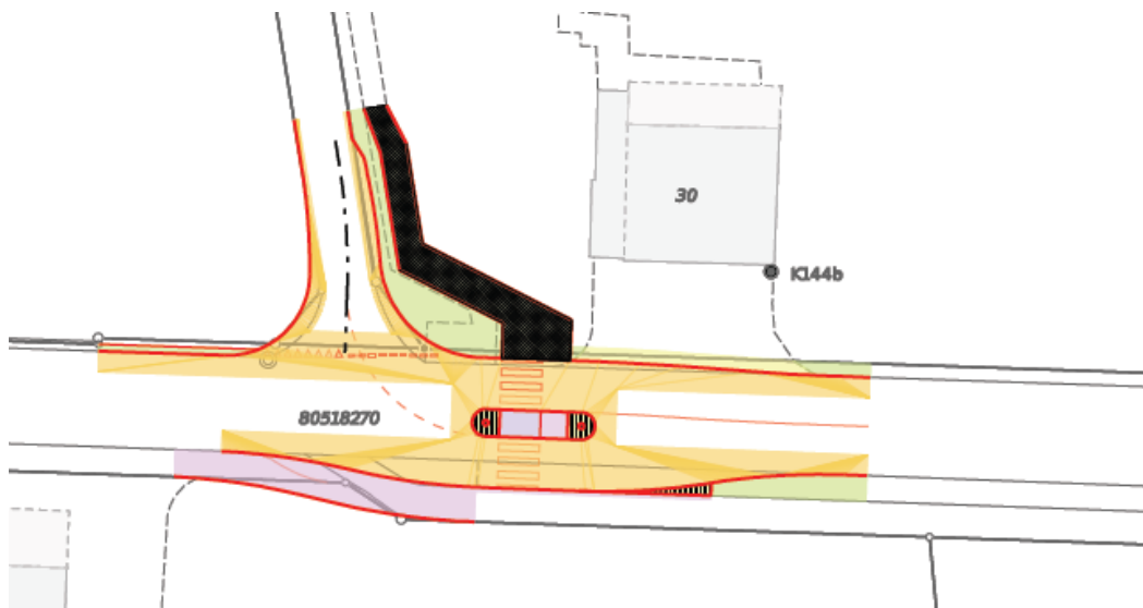
Fussgängerübergang mit Schutzinsel beim Schulhaus
